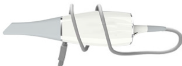
Figura 8 Conservazione errata del cavo dello scanner
